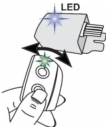
**a.-** Mantener presionado un botón del control remoto bien cerca del receptor haciendo movimientos suaves del mismo hasta que el LED azul destelle rápidamente, luego el LED indicará el Modo actual.
