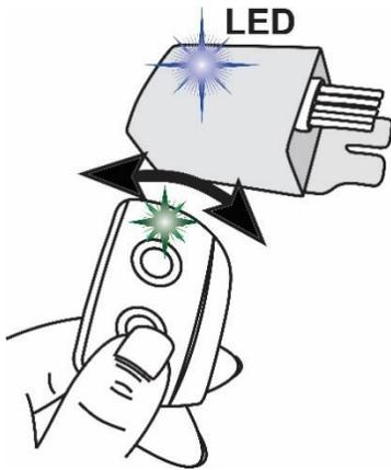
El receptor tiene capacidad para un control remoto Tipo Unicode. Si se desea ingresar un nuevo control remoto sin modificar el Modo de trabajo, realizar el procedimiento **a.-** y desconectar el receptor de la alimentación inmediatamente.
