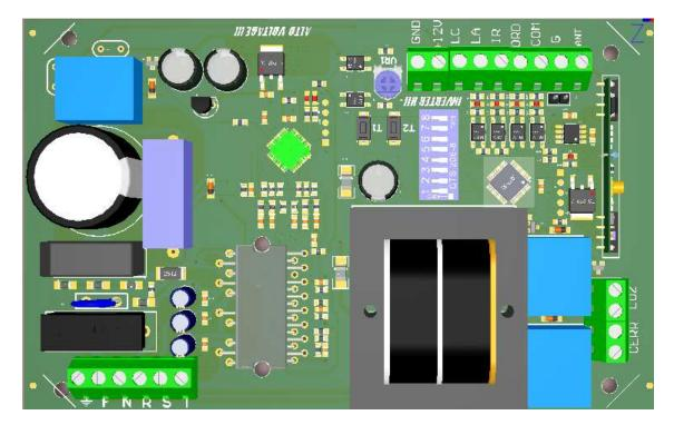
Las borneras "Contacto Luz" y "Contacto Cerradura" son contactos de relé, no entrega ningún tipo de tensión.
