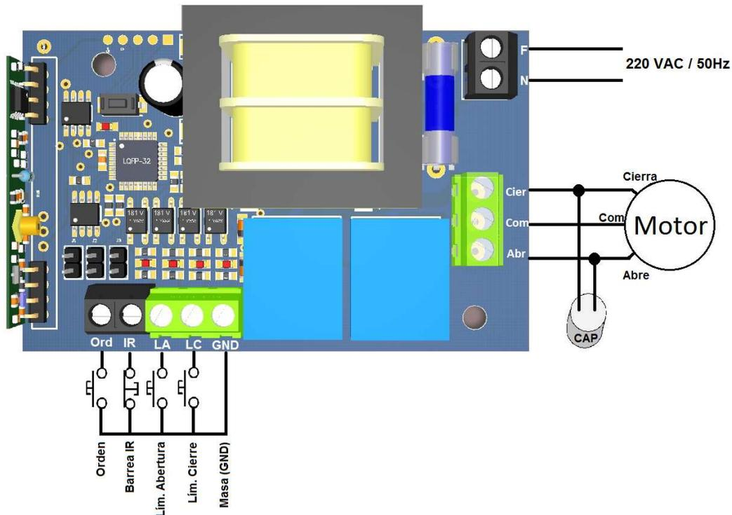
Entrada de Barrera Infrarroja es NC - Si no se utiliza la entrada (IR), debe colocarse un puente.-
